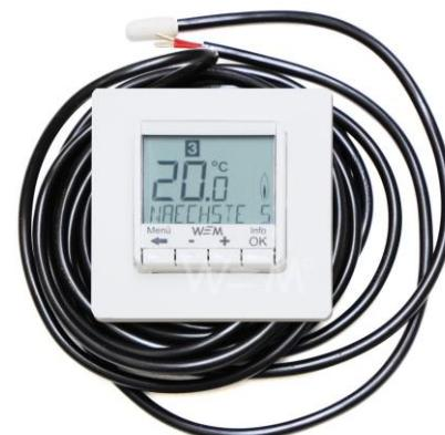
An einen Regler lassen sich max. 2.300 W (8,8 – 10 m<sup>2</sup>) Wandheizung anschließen. Sollte das für sehr große Räume nicht ausreichen, werden entweder mehrere Regler (Temperaturzonen) eingesetzt oder ein Relais zwischengeschaltet.
